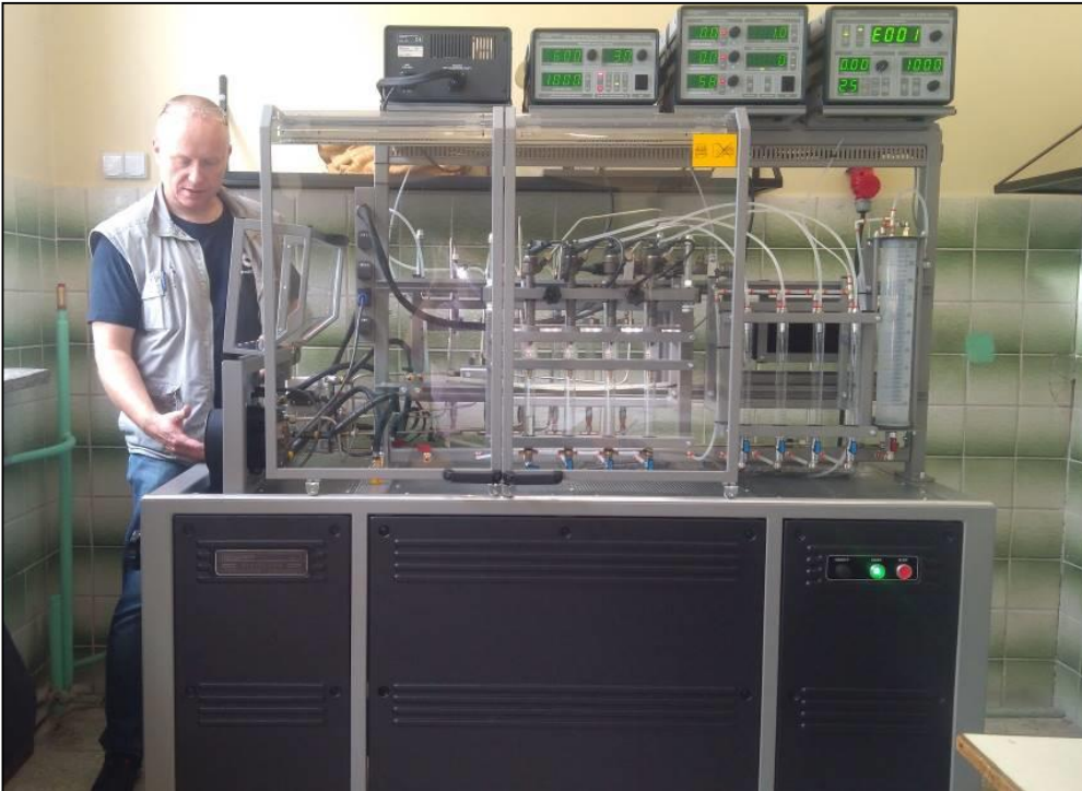
CKZ przy ZSTE Myślenice - Pracownia pomp: mobilne stanowisko do testowania pomp i wtryskiwaczy w systemie Common Rail oraz pomp i wtryskiwaczy w systemie TDI.
