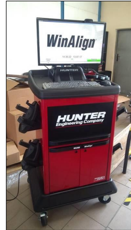
CKZ przy ZSTE Myślenice - Pracownia diagnostyki samochodowej: urządzenie do geometrii kół 3D, przeznaczone jest do nauki procedury ustawienia zbieżności kół w technologii 3D.
